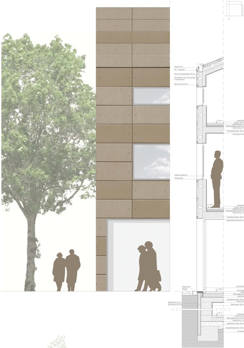
Fassadenansicht/ Fassadenschnitt M 1/25
